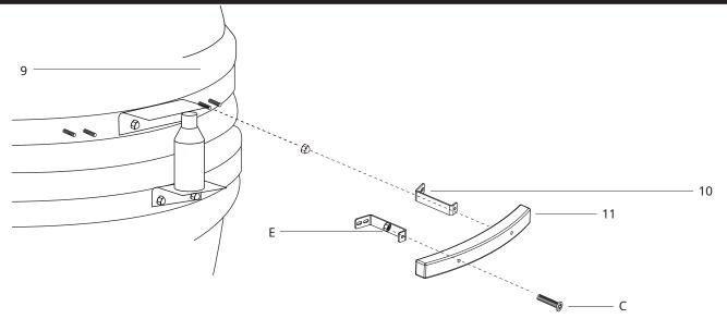
SCHRITT10 - Um den Griff (10) am Deckel des KamadoGrills (9) zu befestigen, befestigen Sie zunächst zwei Griffhalterungen (11) mit den zwei vormontierten Schrauben und Hutmuttern. Befestigen Sie den Griff (11) mit 2 Schrauben (C) und Muttern (E) an den Halterungen (10).
