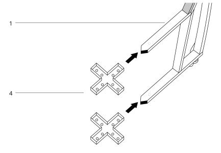
SCHRITT 2 -Um den Wagen zusammenzubauen, stecken Sie die beiden Querstücke (4) von oben und unten in eine der vier Halterungen (1). unten.
