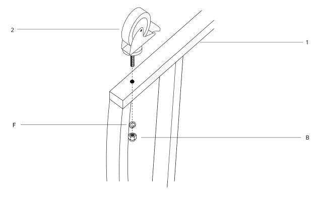
**SCHRITT 1** -Befestigen Sie die vier vorgeschraubten Lenkrollen (2 und 3) an jeder der vier Halterungen (1), indem Sie sie hineinschieben durch das Loch. Befestigen Sie jedes Lenkrad mit einem verstellbaren Schraubenschlüssel mit einer Mutter (B).
