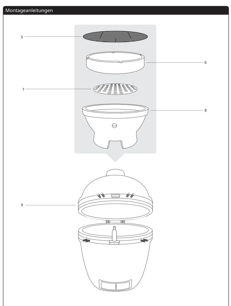
SCHRITT 8 - Wenn der Grill sicher auf dem Wagen platziert ist, fügen Sie den Feuerraum (8), die Holzkohleplatte (7), den oberen Ring (6) usw. hinzu Grillrost (5) im Inneren des Kamado-Grills anbringen, wie im Montageplan dargestellt.
