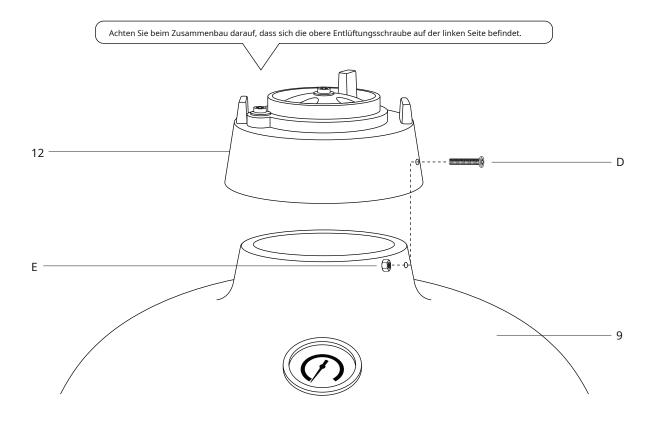
SCHRITT 11 -Um die obere Lüftungsöffnung (12) am Kamado-Grill (9) zu befestigen, platzieren Sie sie oben und richten Sie beide Schraubenlöcher aus. Sicher mit 2x Schrauben (D) und Muttern (E). Achten Sie beim Zusammenbau darauf, dass sich die obere Entlüftungsschraube auf der linken Seite befindet.
