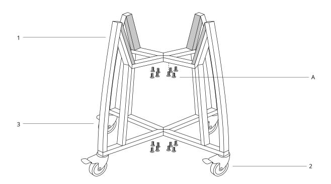
**SCHRITT 4** -Befestigen Sie die Halterungen (1) mit den 16 Schrauben (A) an den Querstücken (4). Stellen Sie sicher, dass der Wagen sicher ist und alle Schrauben fest angezogen sind, bevor Sie den Kamado-Grill (9) hineinstellen.
